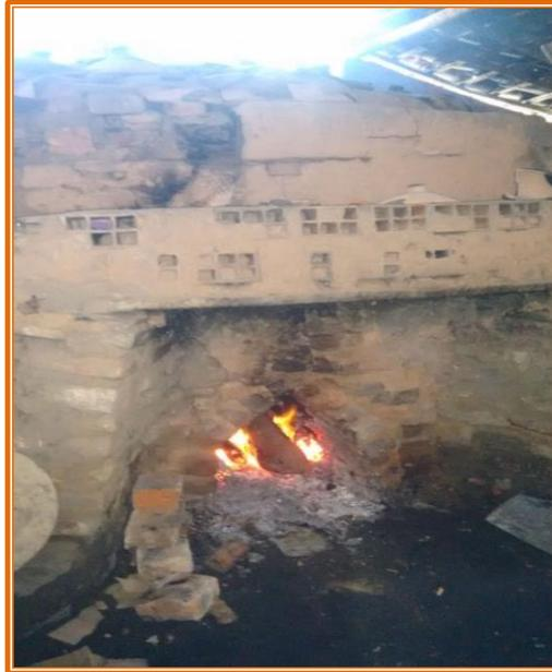
**Figura 37. Imagem do forno utilizado para queimar as peças**
